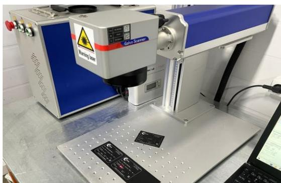
*Изготовление шильды на волоконном лазерном гравере*
