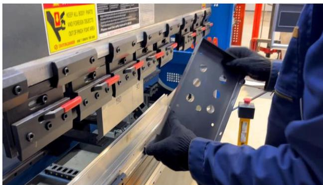
*Передняя стойка конвектора в процессе изготовления*
